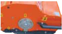
Трубчатые ползья с защитой от зацепления
