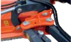
Вращающиеся соединения с использованием самосмазывающихся втулок
