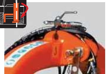
Гидравлический блокирующий кран с ручной активацией (не нужно цепей/кронштейнов)
