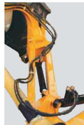
Гидравлический цилиндр смещения размещен внутри рамы, что предотвращает повреждения во время работы
