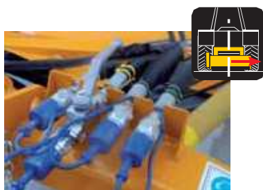
Блокировка гидроцилиндра смещения для транспортировки (не требуются доп. цепи/кронштейны)
