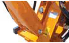
Рама "DELTA BOX" (отбалансированный крепёж к трактору)
