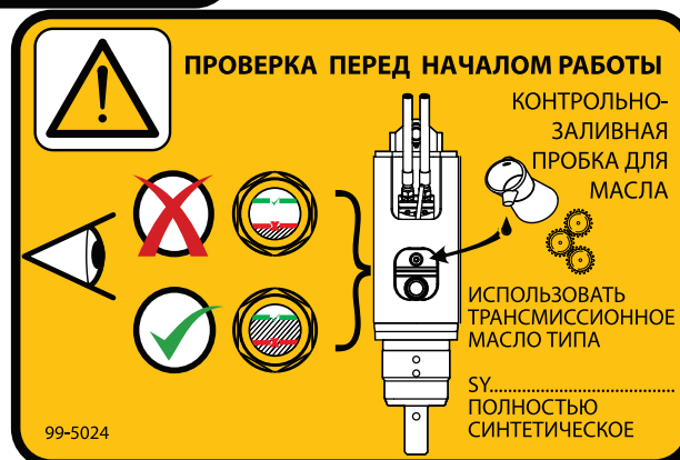
Предупреждающая табличка для контроля уровня масла на рис. образец таблички моделей RD30 и RD50
